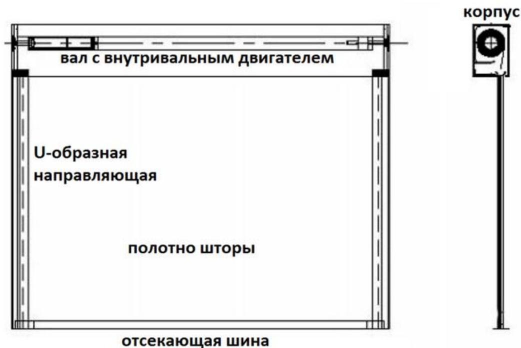
Рисунок 3 – Конструктивные элемента противопожарной стены (шторы)
