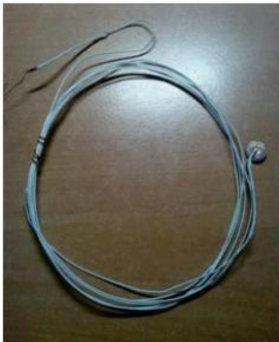
Рисунок 7 – Лепестковые термопары типа «хромель-алюмель»
