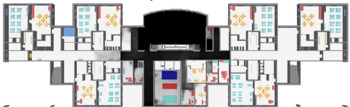
Рисунок 10 – Этаж 2. Концентрация HCl на высоте 1,7 м от уровня этажа. Время: 165,2 с.
