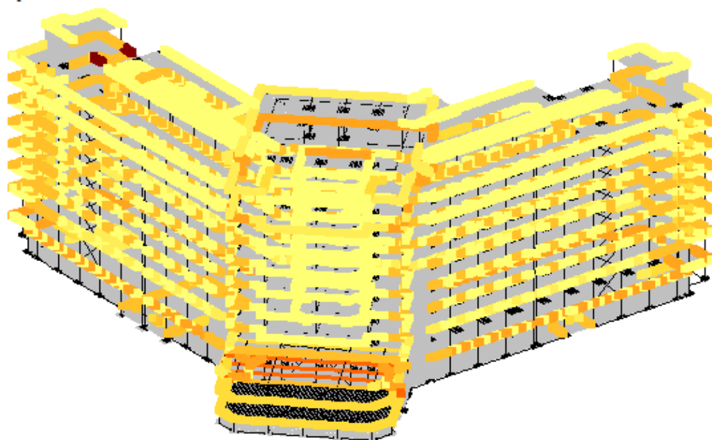
Рисунок 4 – Равномерно распределенные нагрузки по длине от полов
