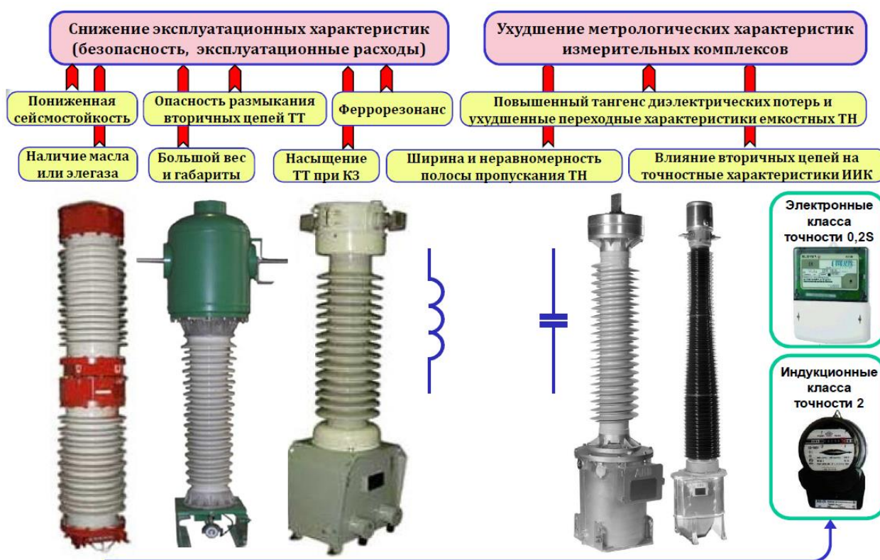
Рисунок 7 – Ключевые недостатки традиционных измерительных трансформаторов
