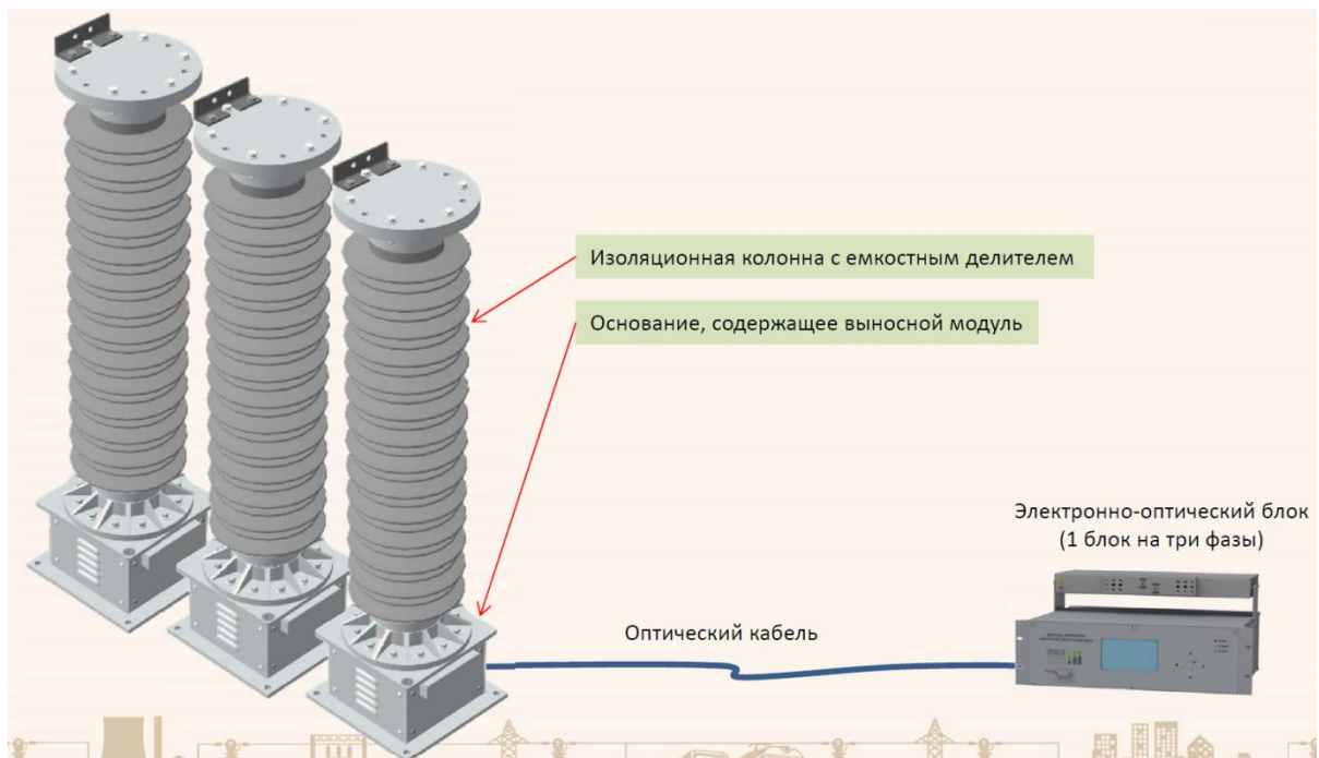
Рисунок 11 – Конструкция оптического трансформатора напряжения
