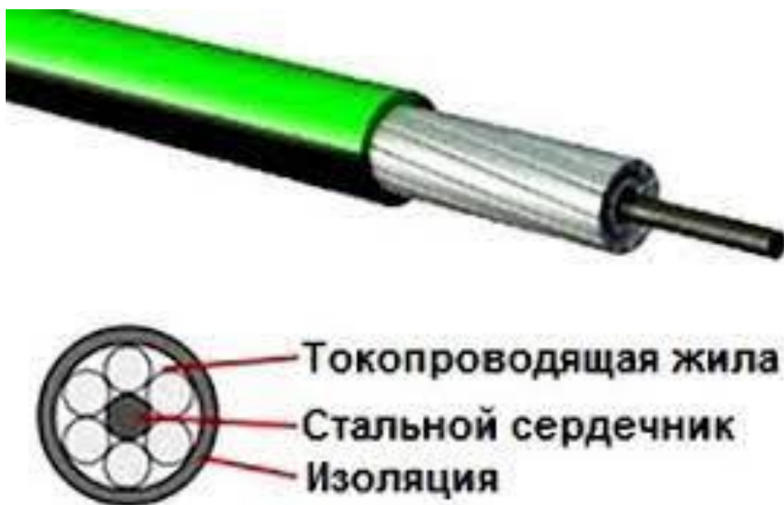
Рисунок 3 – Конструкция провода марки СИП-3
