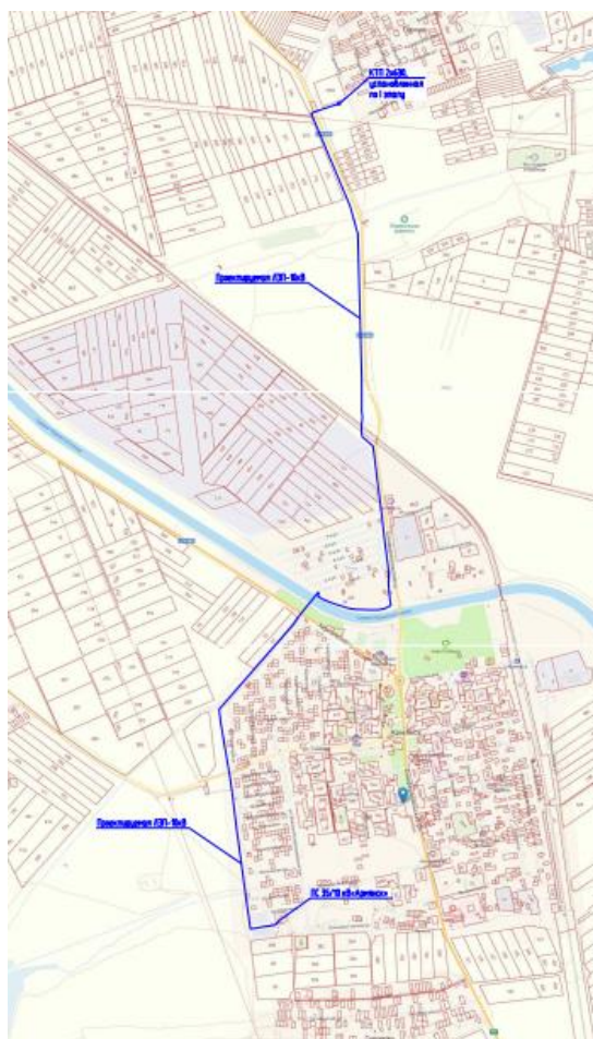
Рисунок 2 – Ситуационный план на местности проектируемой воздушной линии 10 кВ от источника питания (ПС-35/10 кВ «Армянск») до потребительской КТП-10/0,4 ретранслятора «Радиотелевизионный передающий центр Республики Крым»
