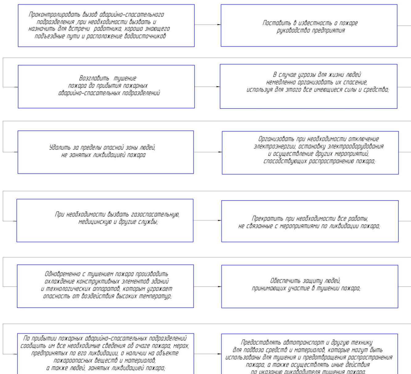
Рисунок 7.1 – Схема - инструкция по руководству и действиям работников транспортного цеха при возникновении чрезвычайной ситуации – пожара.
