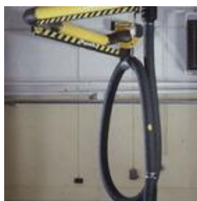
Рисунок 4.5 - Консольно-поворотное вытяжное устройство «FEB» консольно-поворотное вытяжное устройство, крепление к стене, для авто с мощностью двигателя до 300 л.с. и более. Производитель:
