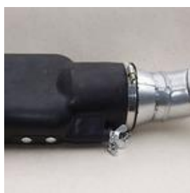
Рисунок 4.10 - Резиновая газоприемная насадка «REC» резиновая насадка, стальной полуотвод, отверстие для отбора проб CO 2 , внутренний зажим для крепления, заслонка
