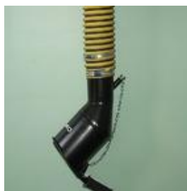
Рисунок 4.5 - Стальная газоприемная насадка «MEN/SP» стальная с полуотводом 45 град., отверстие для отбора проб CO 2 производитель: ЗАО «СовПлим»
