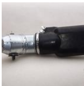
Рисунок 4.9 - Резиновая газоприемная насадка «REN» резиновая насадка, стальной полуотвод, отверстие для отбора проб CO 2 , заслонка
