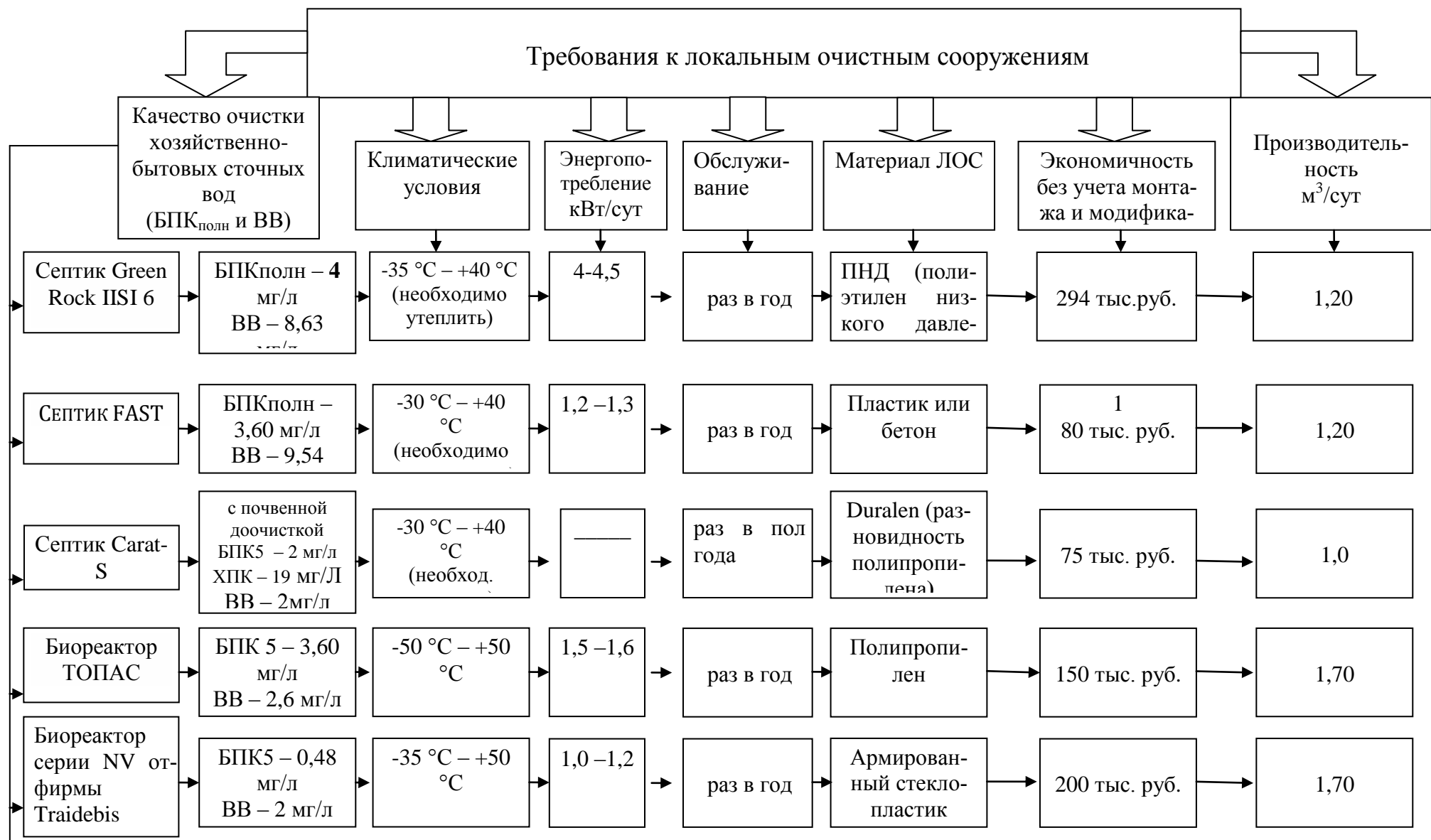
Рисунок 9 – Требования к локальным очистным сооружениям (4-6 чел.)
