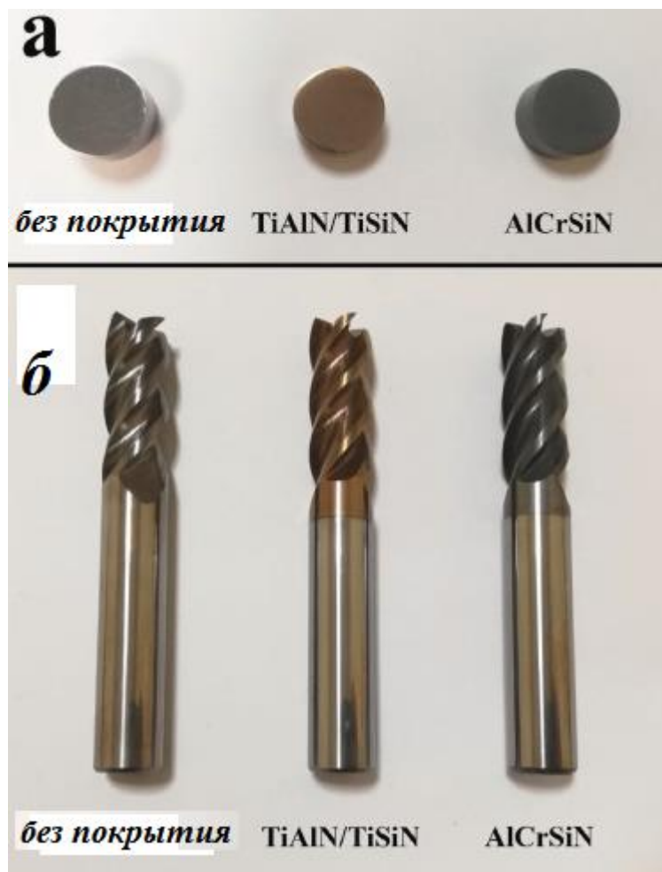
Рисунок 11 – Образцы с двухслойными покрытиями TiAlN/TiSiN и однослойными покрытий AlCrSiN , а также образцы без покрытия
