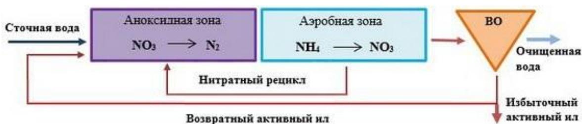
Рисунок 6- Технологическая схема нитрификации
