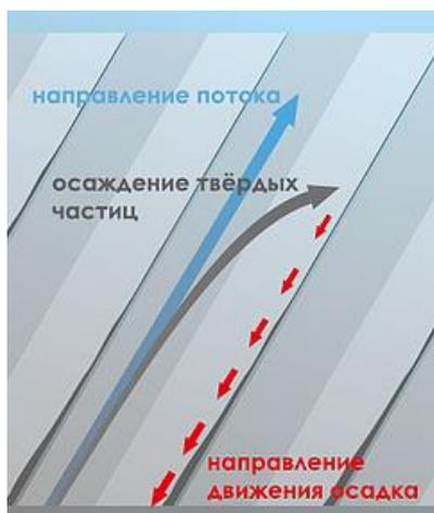
Рисунок 8 - Принцип работы тонкослойных блоков
