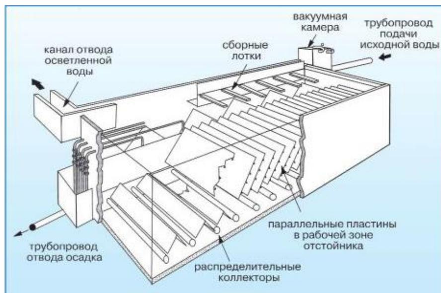
Рисунок 7– Общий внешний вид тонкослойного отстойника
