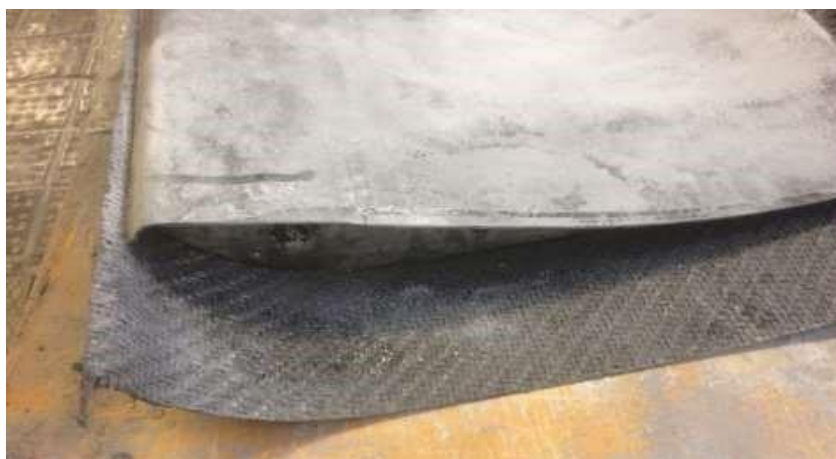
Рисунок 32 – Композитный материал для изготовления поверхности крыльев
