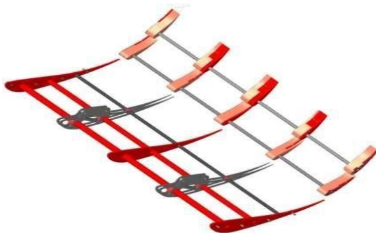
Рисунок 29 – Заднее антикрыло, 3D-модель пространственной рамы.
