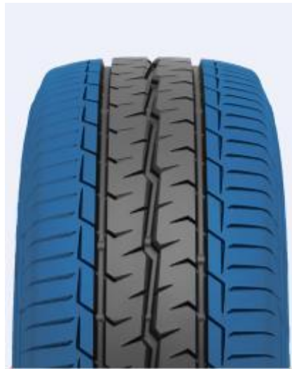
Рисунок 27 - участки шины для замера температуры
