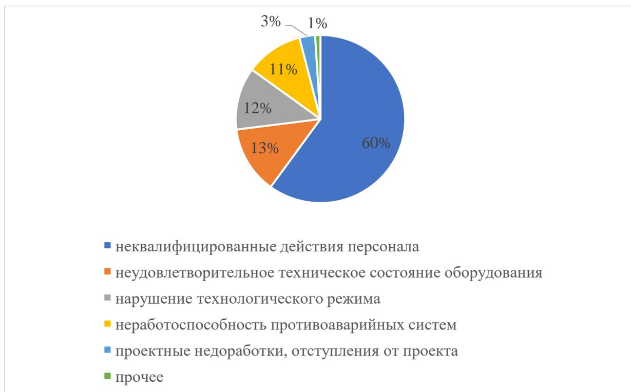
Рисунок 10 – Процентное распределение основных причин аварийности в АО «Самаранефтегаз»
