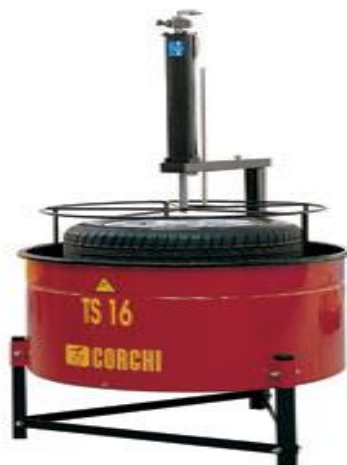
Рисунок 4 – Стенд проверки на герметичность камер и колес легковых автомобилей AREO SUB 820T
