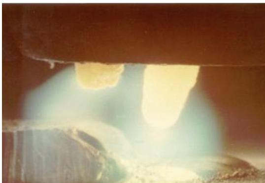
Рис. 2.16. Наплавка трехфазной дугой с подачей крупногабаритной присадки
