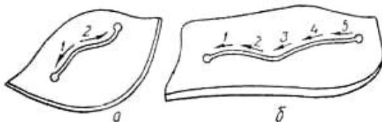
Рис. 2.6. Заварка коротких (а) и длинных (б) трещин
