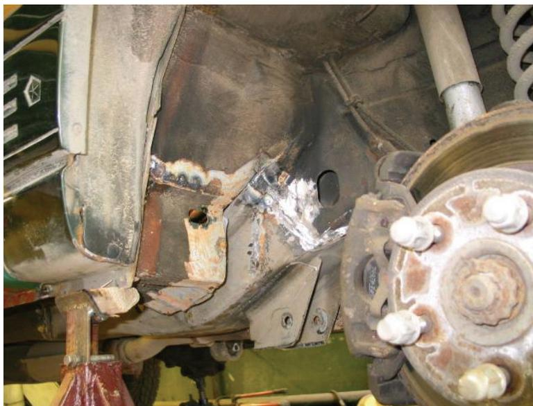
Рис. 4.2. Сварка переднего лонжерона кузова автомобиля
