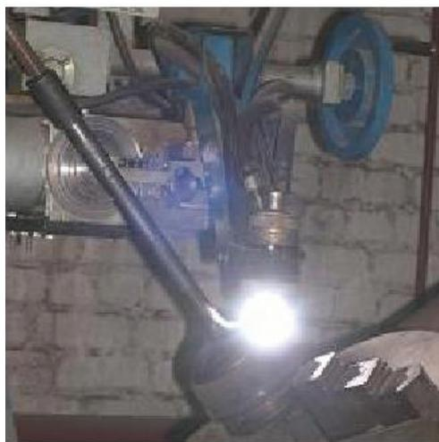
Рис. 4.14. Процесс плазменно-порошковой наплавки фаски клапана
