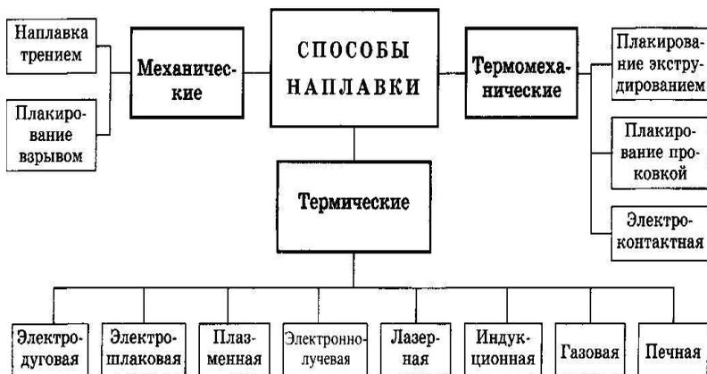
Рис. 1.1. Способы наплавки
