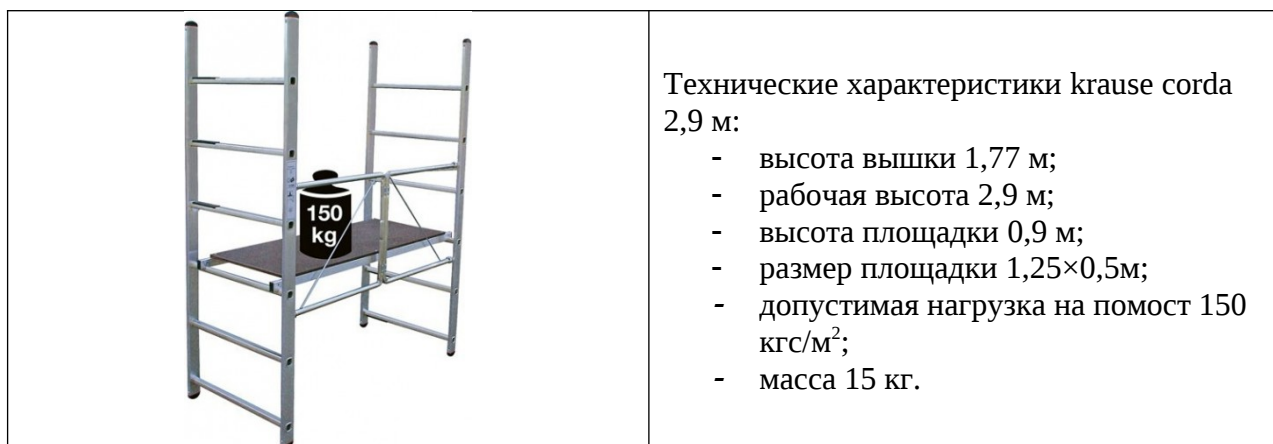
Рисунок 10 – Лестничные подмости krause corda 2,9 м складывающиеся
