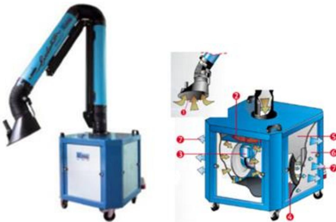
1 - поворотное устройство; 2 - вентилятор; 3 - камера; 4 - картриджный фильтр; 5 - картриджный фильтр; 6 - фильтр с активированным углём; 7 - выход чистого воздуха
