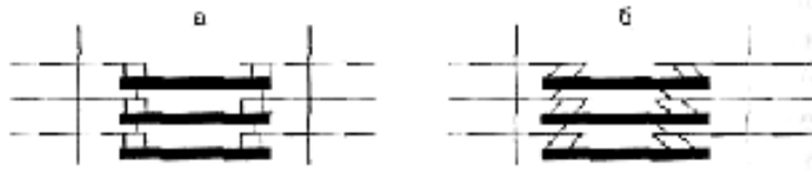
Рис. 4. а) образовавшиеся мостики между толстыми и тонкими нитями располагаются под углом 90^\circ ; б) после разворота мостики оказываются под углом 45^\circ
