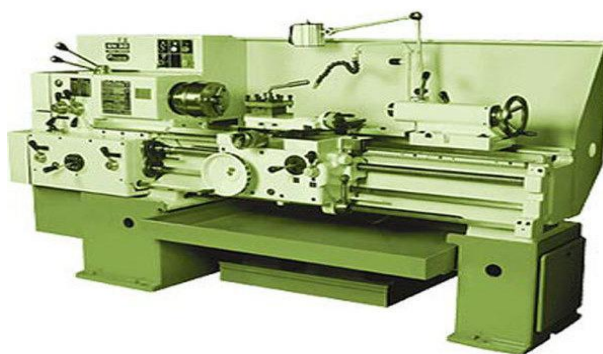
Рисунок 1.2- Токарный станок изготовления детали вала
