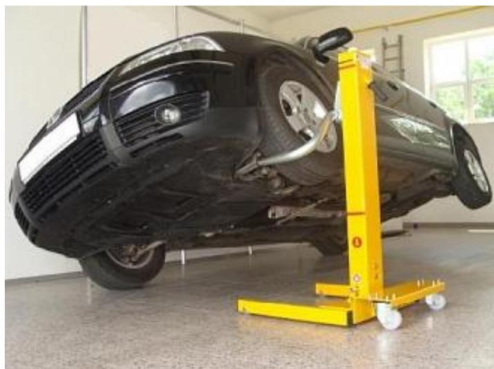
Рисунок 2.2 – Одностоечный автомобильный подъемник S Z 1500
