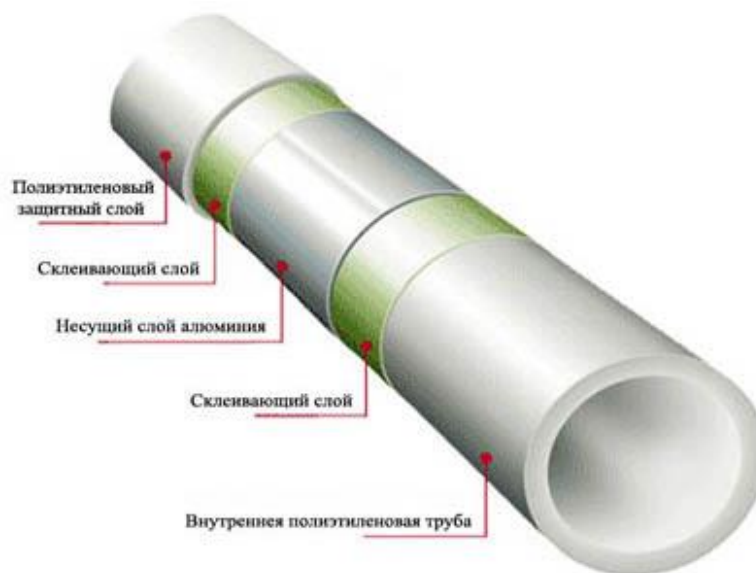
Рисунок 4.1 – структура металлопластиковой трубы
