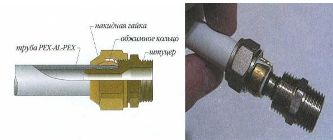
Рисунок 4.2 - Компрессионный фитинг для металлопластиковых труб
