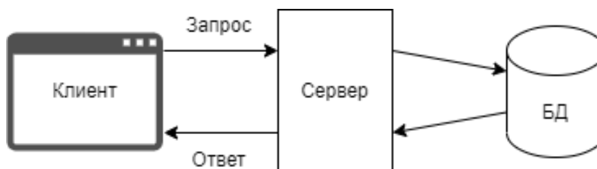
Рисунок 19 – Модель двухзвенной клиент-серверной архитектуры с тонким клиентом
