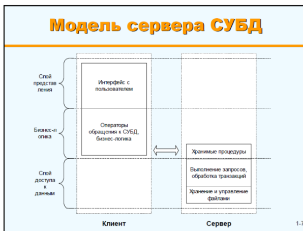
Рисунок 26 – Двухзвенная архитектура «клиент – сервер»
