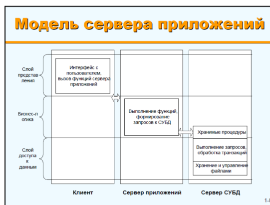
Рисунок 27 – Трехзвенная архитектура «клиент – сервер»
