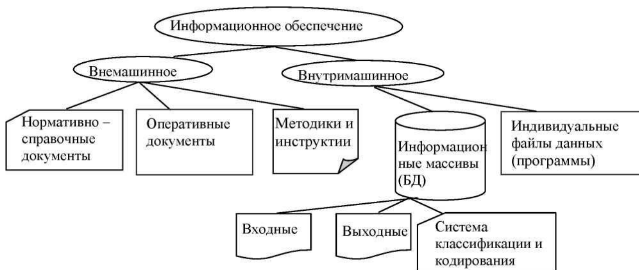
Рисунок 5 - Организация информационного обеспечения в АИИС КУЭ ПС 220кВ «Левобережная»
