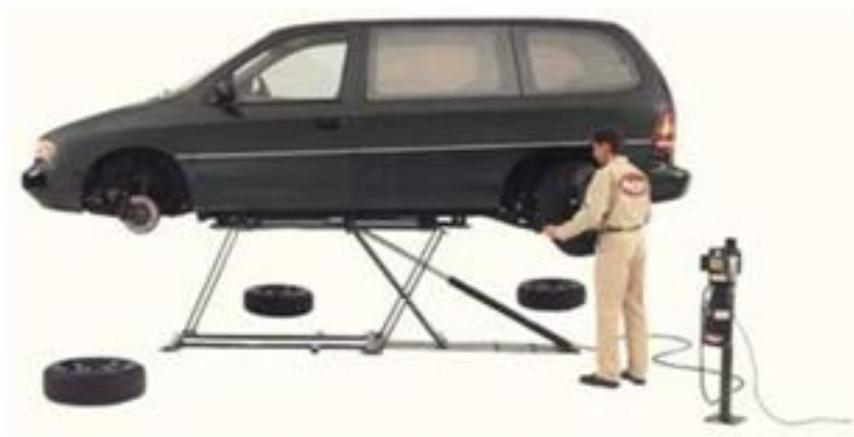
Рисунок 1.3 - Пневмогидравлический подъёмник для кузовного ремонта
