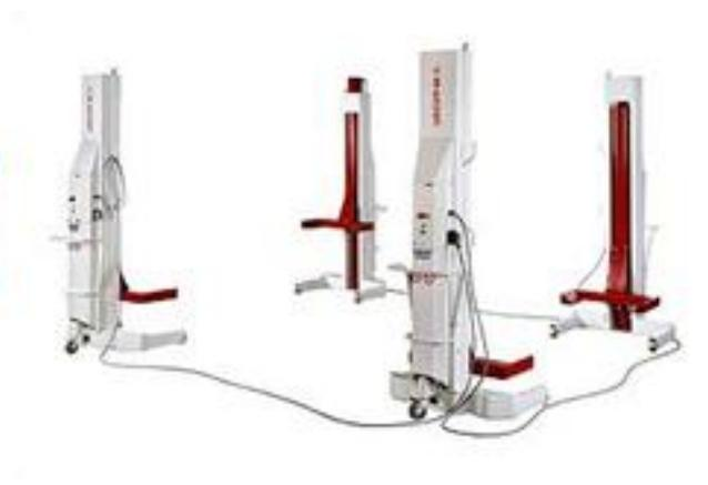
Рисунок 1.1 - Мобильные колонные подъемники
