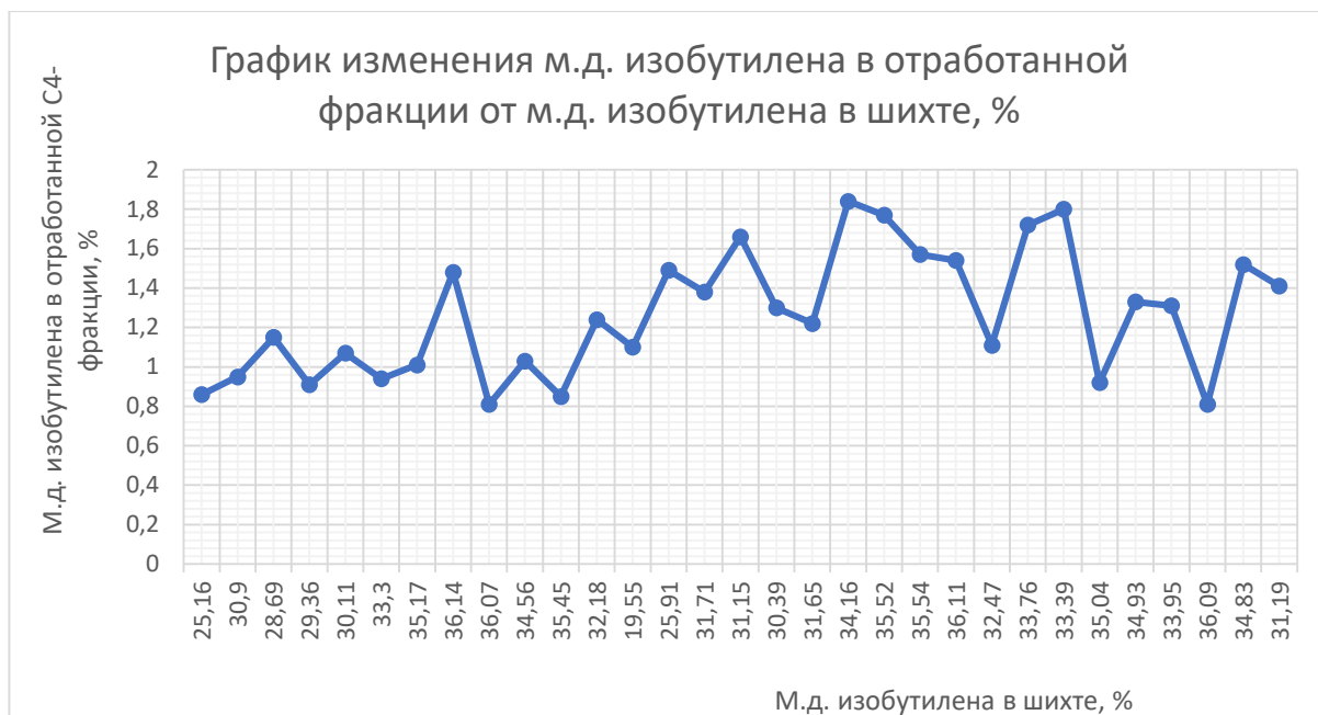
Рисунок 14 – График изменения массовой доли изобутилена в отработанной фракции от массовой доли изобутилена в шихте
