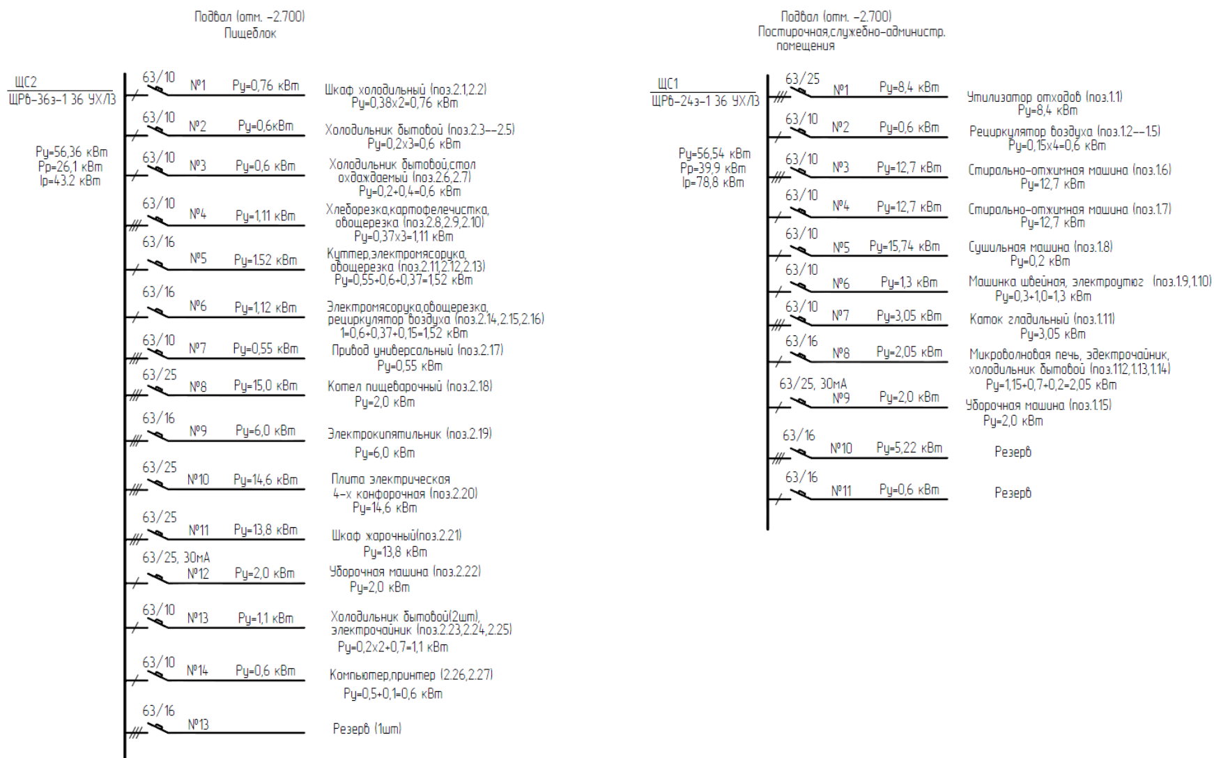
Рисунок 2 - Распределение силовых электроприемников по ЩС1 и ЩС2
