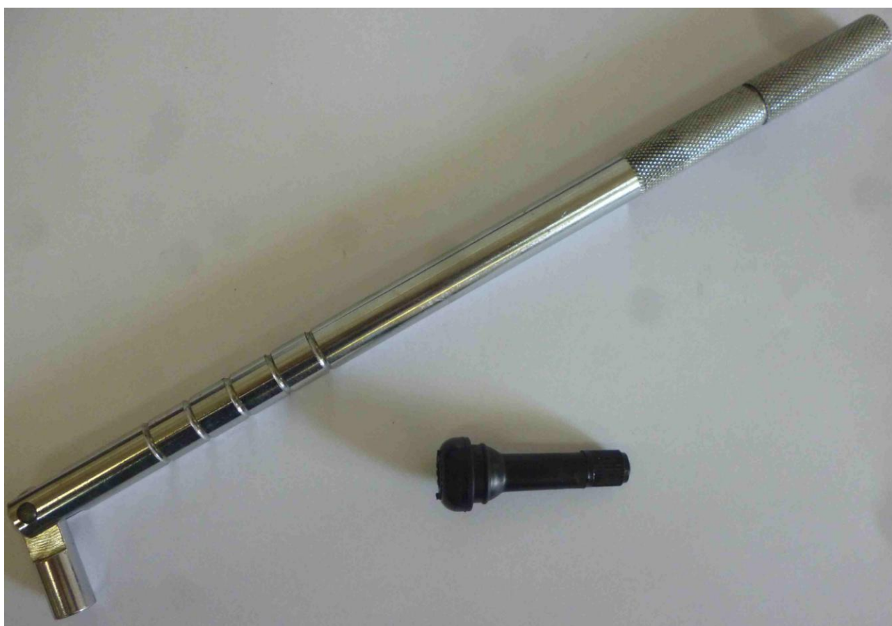
Рисунок 4.6 – Бескамерный вентиль и приспособление для установки
