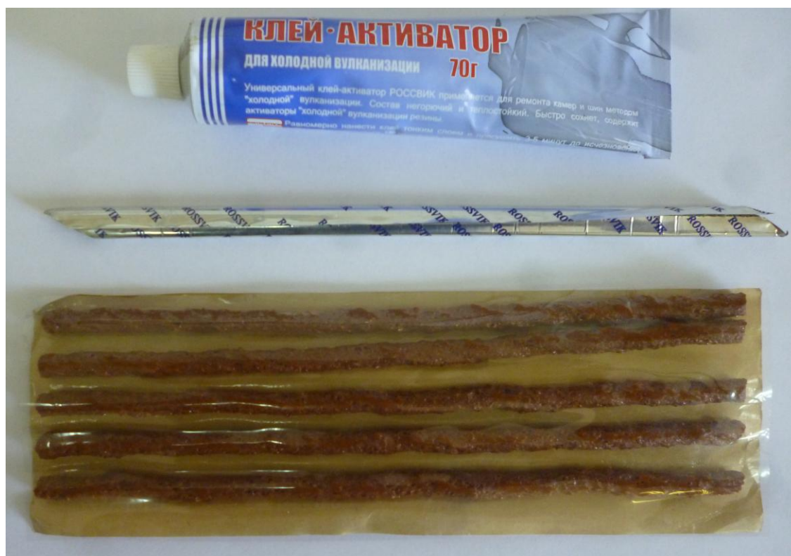
Рисунок 4.2 – Материалы для ремонта шин
