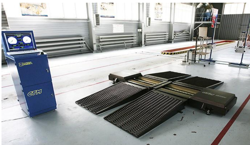
Рисунок 3 – Испытательный стенд СНТ-2.0
