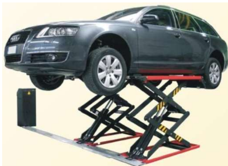
Рисунок 10 – Рабочее положение автомобиля при снятии колес
