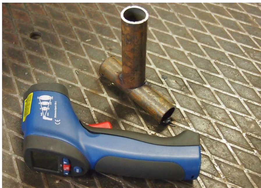
Рисунок 26 – Перпендикулярное соединение труб для проведения исследования и пирометр
