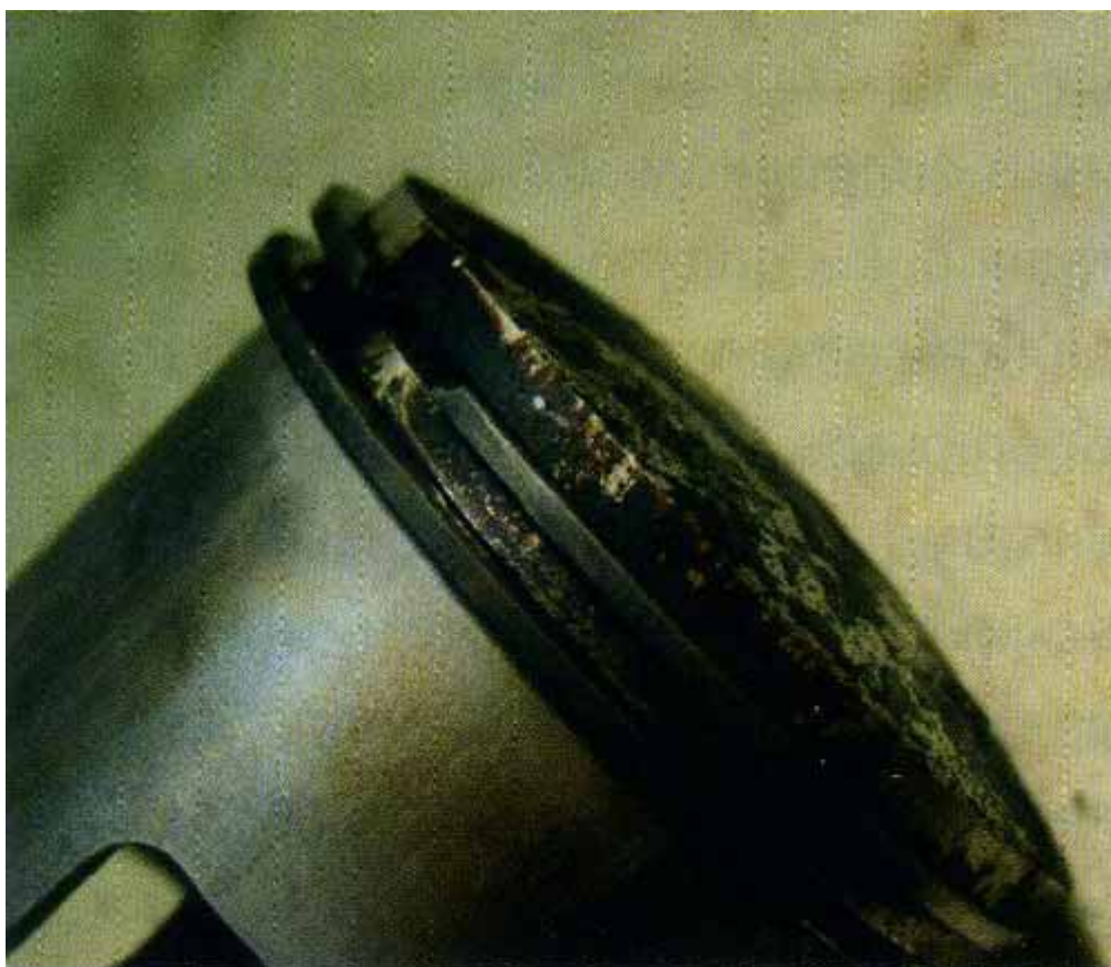
Рисунок 8 – Последствия износа поршня при несоответствии типа смазки, рекомендуемой производителем двигателя
