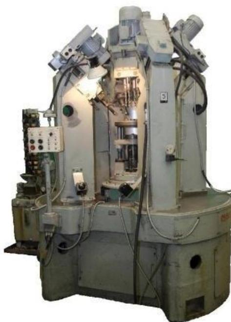
а - токарно-фрезерный станок модели АБ3089
