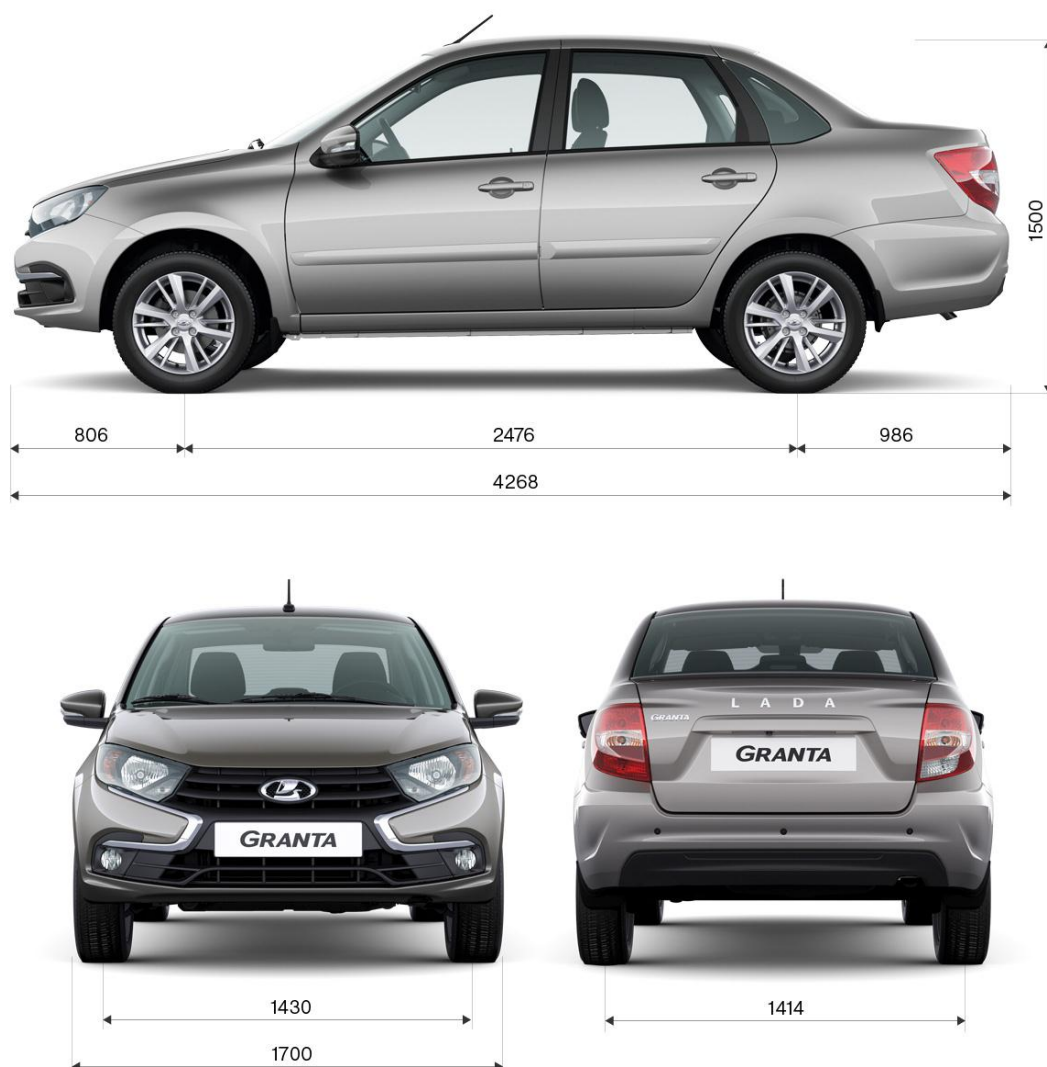
Рисунок 1 – Габаритные размеры автомобиля LADA GRANTA
