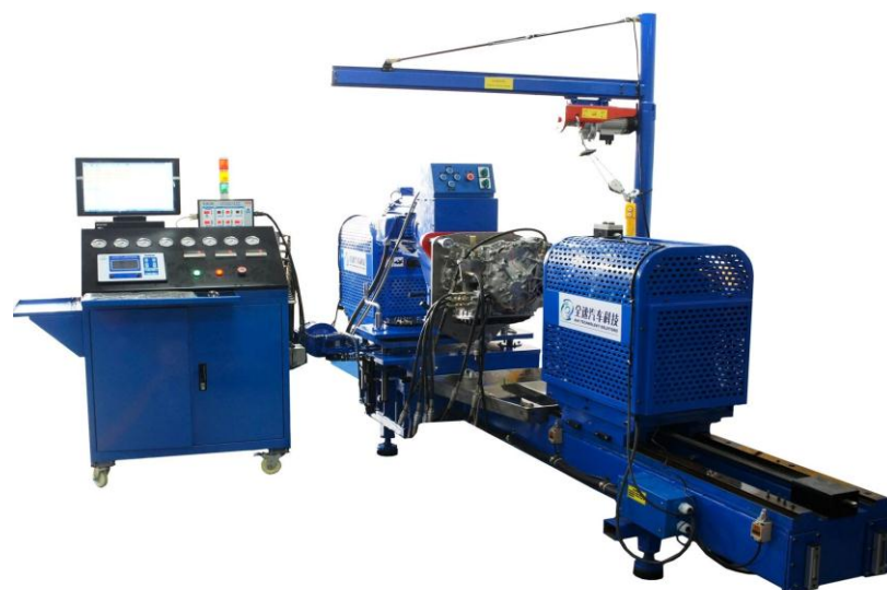
Рисунок 4 – Внешний вид стенда для испытания АКП
