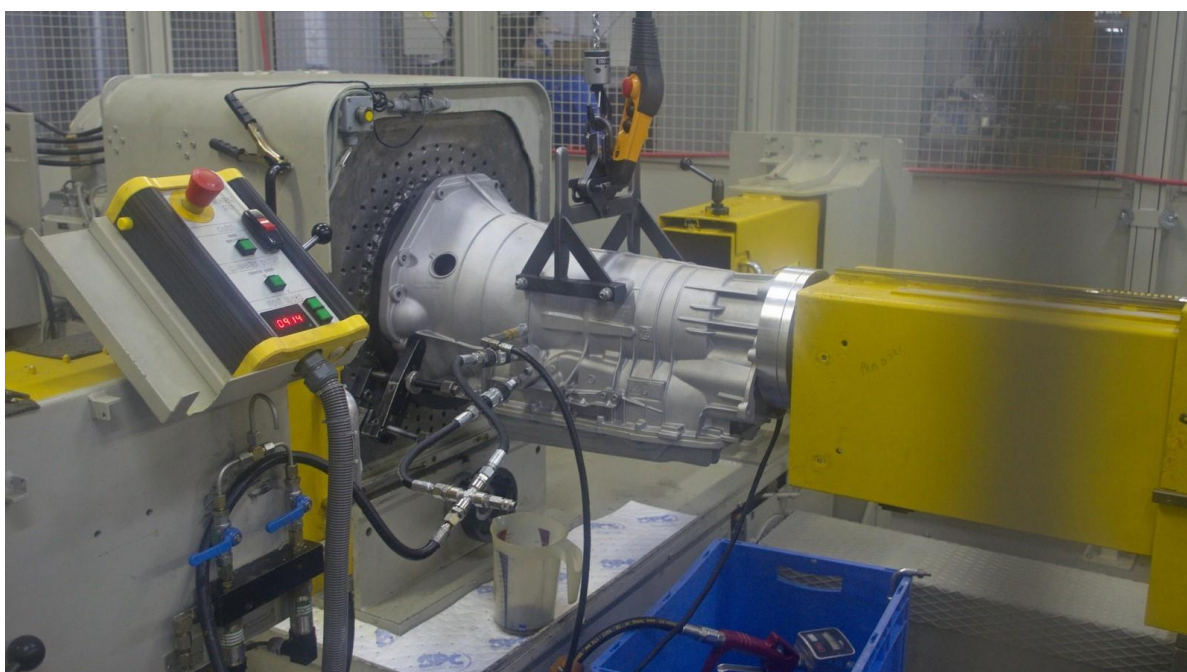
Рисунок 11 – Испытание автоматической коробки передач после восстановления индустриальным методом
