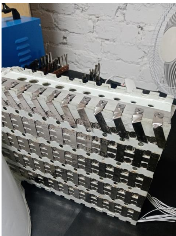
Рисунок 17 – Сборка модулей высоковольтного аккумуляторной батареи
