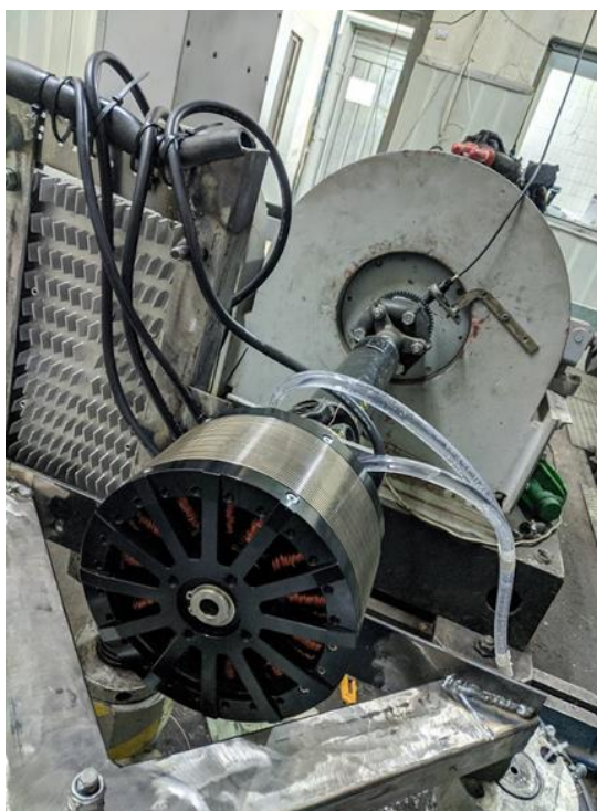
Рисунок 19 – Электрическая тяговая система на стапеле, подключенная к моторному диностенду
