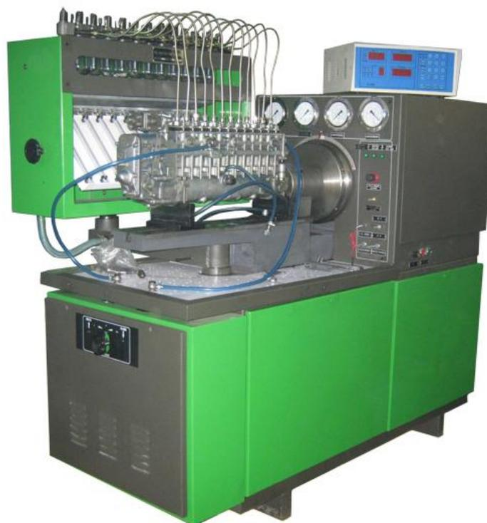
Рисунок 2.2 – Стенд для испытания и регулировки ТНВД - 12PSDB
