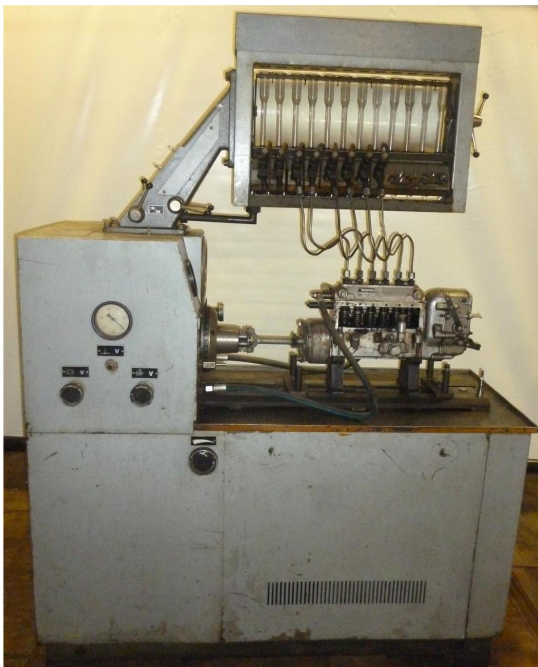
Рисунок 1.1 – Стенд испытания и настройки ТНВД
