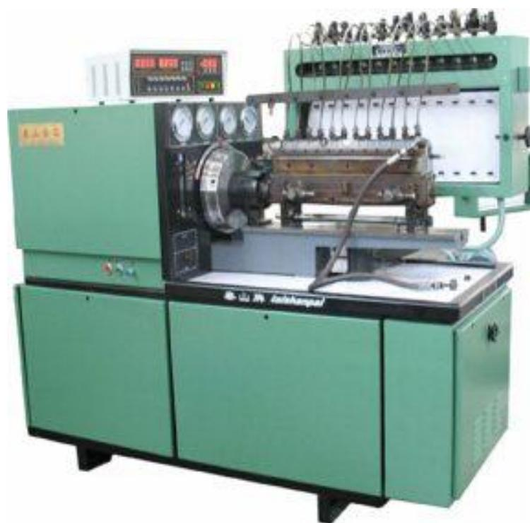
Рисунок 2.3 – Стенд для испытания и регулировки ТНВД с цифровым дисплеем 12PSDB
