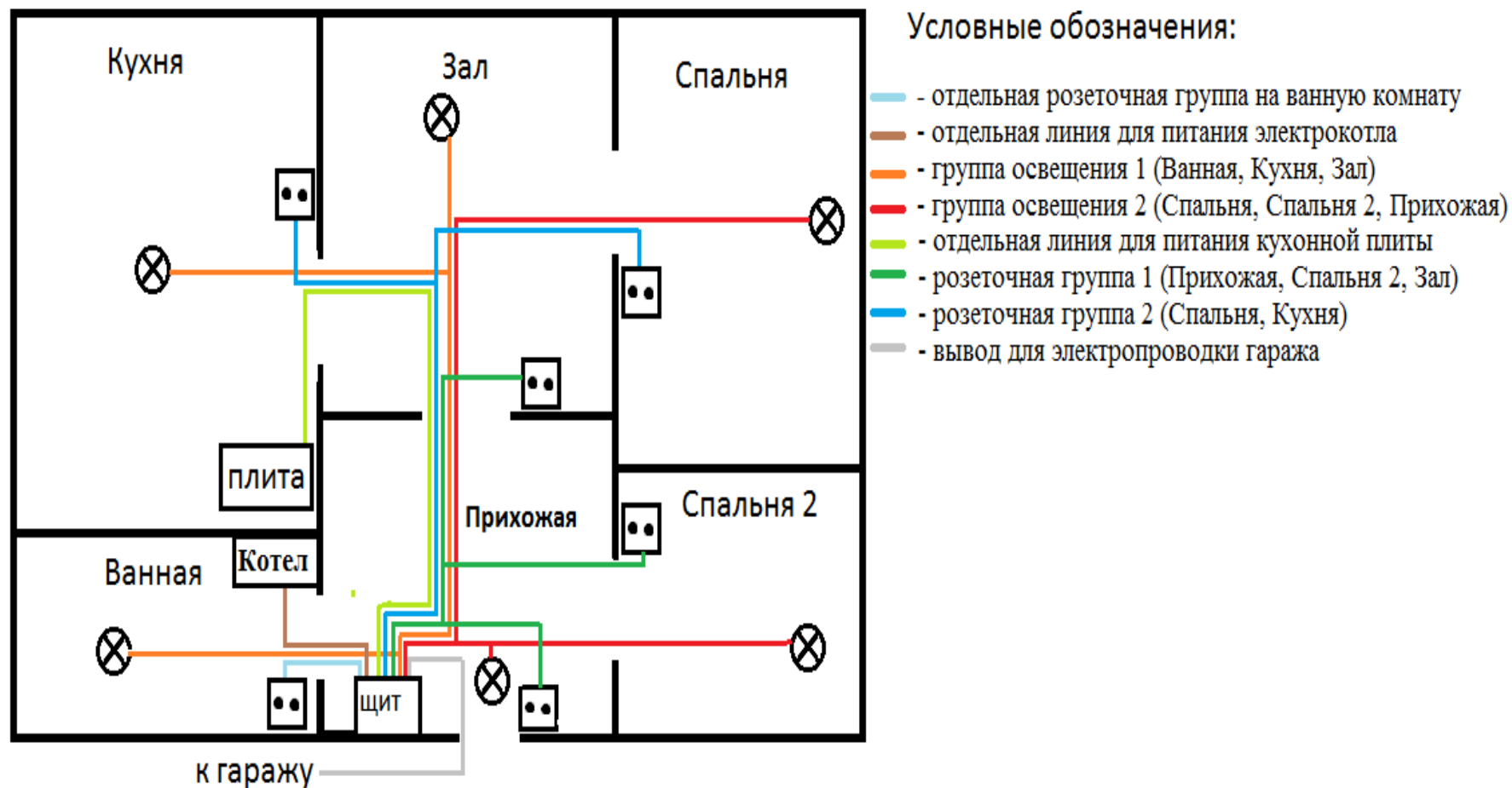
Рисунок 2 – Схема электропроводки в частном доме
