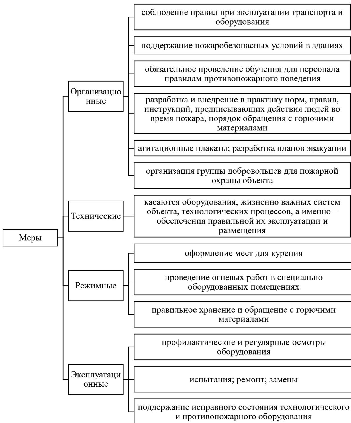
Рисунок 24 - Меры и структурные элементы противопожарной защиты на объектах нефтегазовой отрасли
