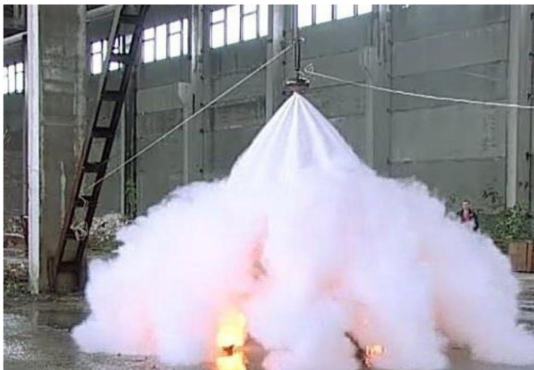
Рисунок 8 - Система порошковых АПС
