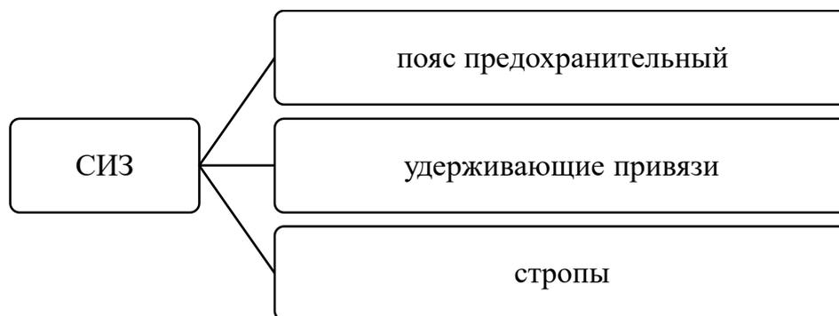
Рисунок 14 - Перечень СИЗ для работ на высоте
