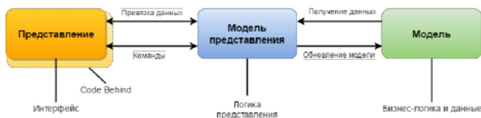
Рисунок 5 – Схема шаблона Model–View–ViewModel (MVVM)
