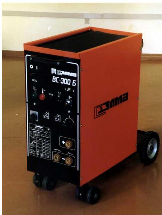
Рисунок 6 – Сварочный выпрямитель ВС-300 Б
