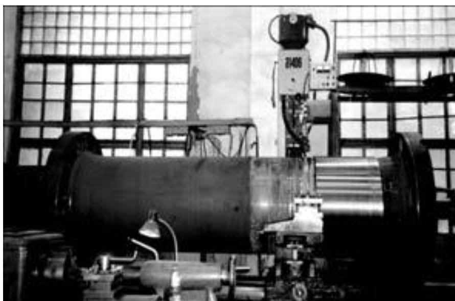
Рисунок 16 – Установка для выполнения восстановительной наплавки под флюсом валов гидротурбин на базе станка РТ-166
