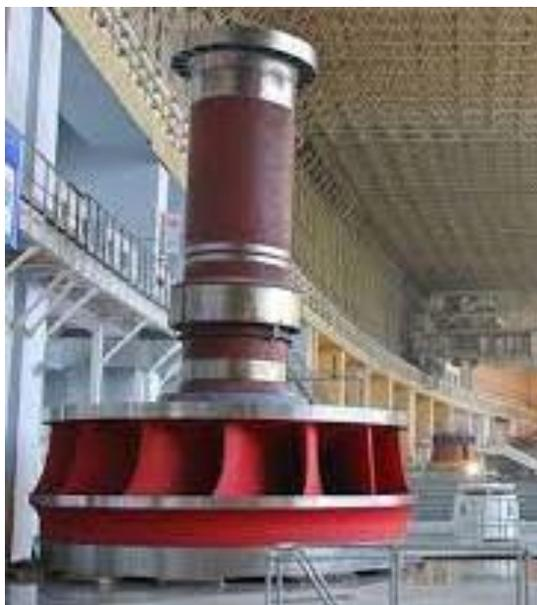
Рисунок 2 – Вал гидротурбины мощностью 250 мВт
