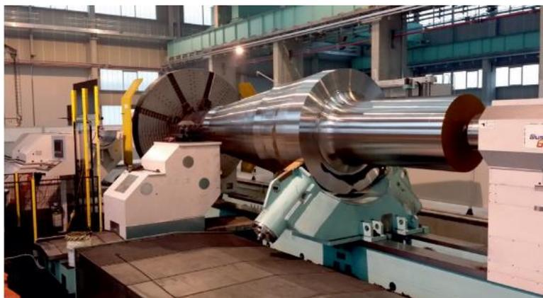
Рисунок 5 – Обточка валов гидротурбин на станке GGTRONIC
