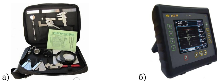
Рисунок 8 – Оборудование для проведения визуально-измерительного контроля (а) и ультразвукового контроля (б) сварных швов
