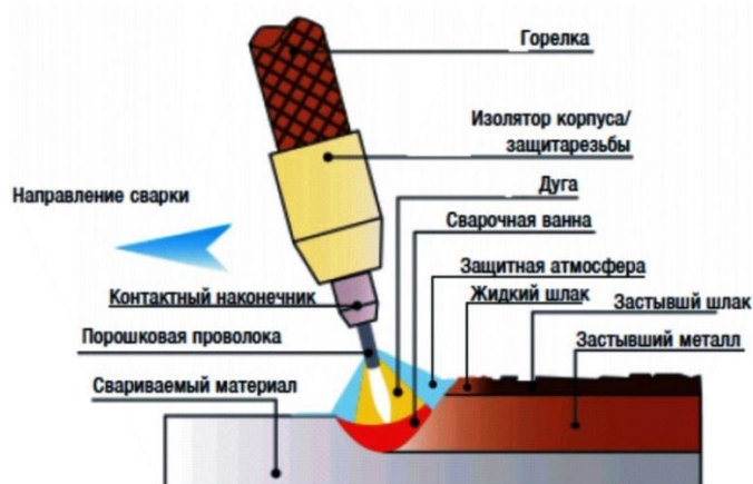
Рисунок 11 – Схема сварки самозащитной порошковой проволокой
