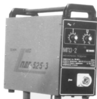
Рисунок 16 – Оборудование для заполнения разделки трещины: источник сварочного тока ВДУ-506 (а) и механизм подачи сварочной проволоки ПДГ-525 (б)
