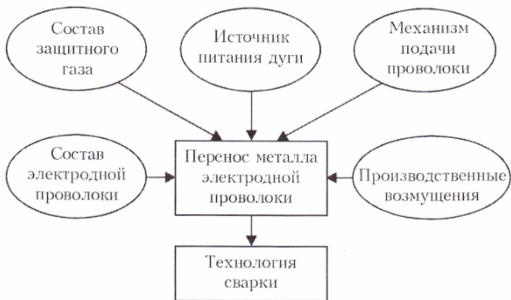
Рисунок 12 – Схема основных параметров сварочного процесса, воздействующих на перенос металла электрода [29]
