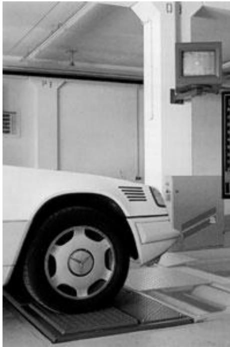
Рисунок 3.1 - Стенд для проверки амортизаторов FWT-1
