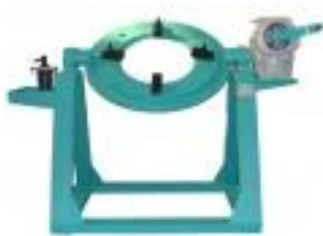
Рисунок 2.4 - Стенд для сборки и разборки редуктора заднего моста автомобилей 24-15
