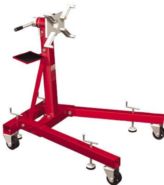
Рисунок 2.2 - Устройство для кантования КП и редуктора 8.53
