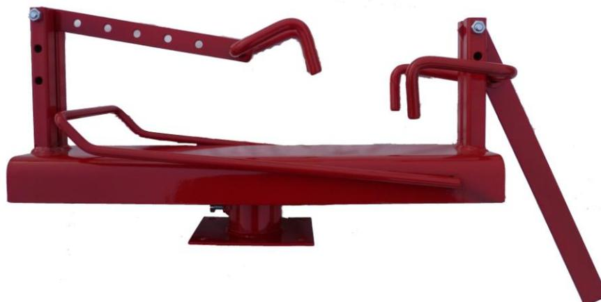
Рисунок 2.4 - Борторасширитель КС – 017
