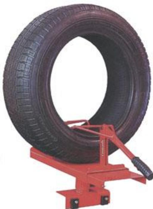
Рисунок 2.2 - Борторасширитель КС-016
