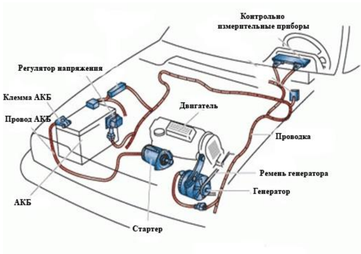
Рисунок 1 – Система электроснабжения автомобиля
