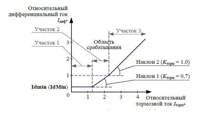
Рисунок 11 — Тормозная характеристика функции дифференциальной токовой защиты нулевой последовательности REF
