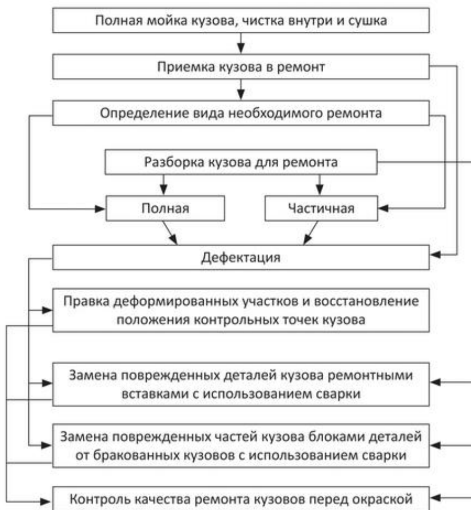
Рисунок 2 – Алгоритм выполнения операций по восстановлению кузовов
