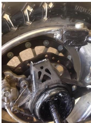
Рисунок 30 – Поломка опорного элемента
