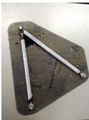
Рисунок 28 – Рычаг подвески в специальной оснастке
