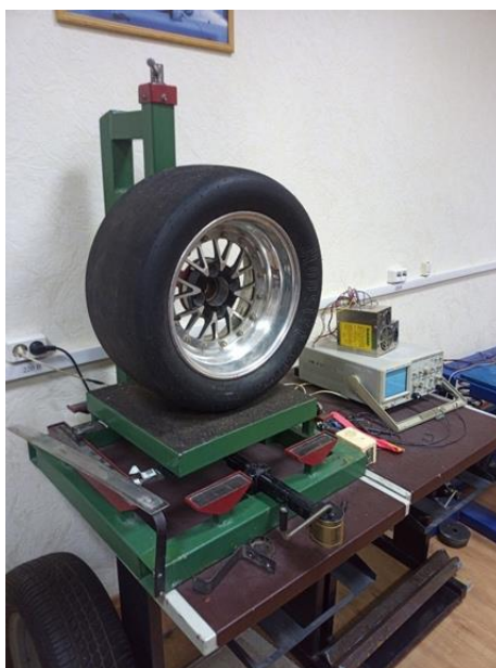
Рисунок 20 – Стенд для определения коэффициента сцепления
