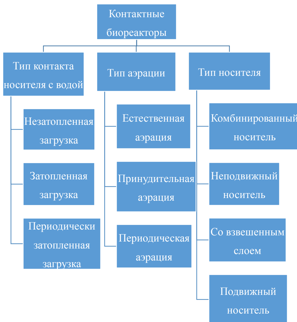
Рисунок 2 – Классификация контактных биореакторов согласно типу аэрации, а также свойствам загрузки биомассы
