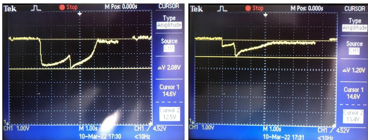
Рисунок 22 – Осциллограммы изменения напряжения бортовой сети во время включения внешних осветительных приборов автомобиля: а) без СК; б) с использованием СК
