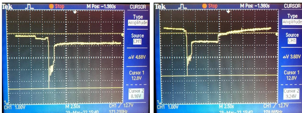
Рисунок 25 – Осциллограммы изменения напряжения бортовой сети во время пуска двигателя: а) без СК; б) с использованием СК
